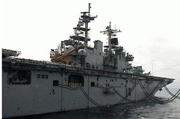
Figur 3. Drivstoffslanger ført mellom to skip ved hjelp av en bærende vaier under en UNREP-operasjon (foto: FAS)
