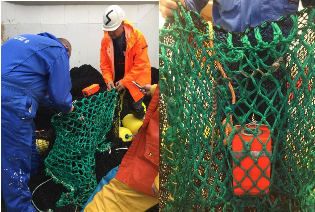
Figur 2. Montering av notøyet i nota ved hjelp av en notpose.
