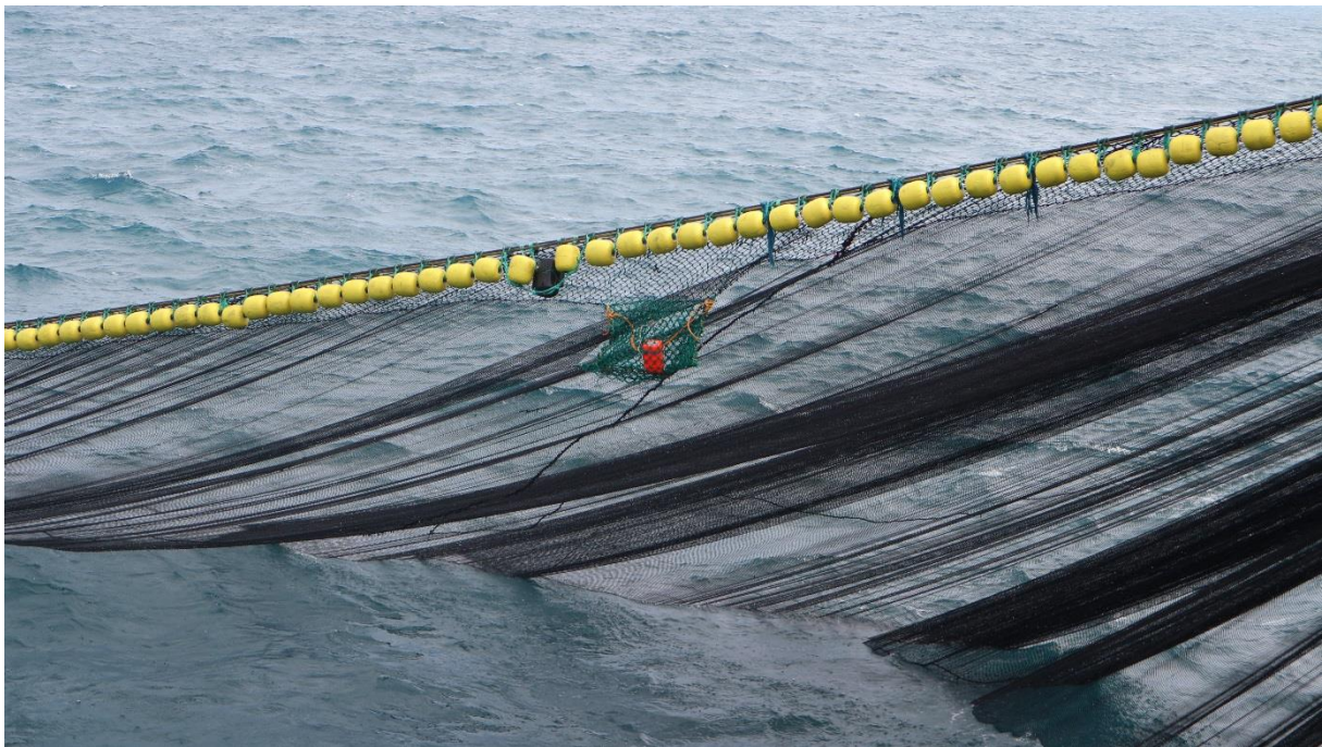
Figur 4. Bilde av notøye som er montert på nota rett før den blir tatt ombord.
