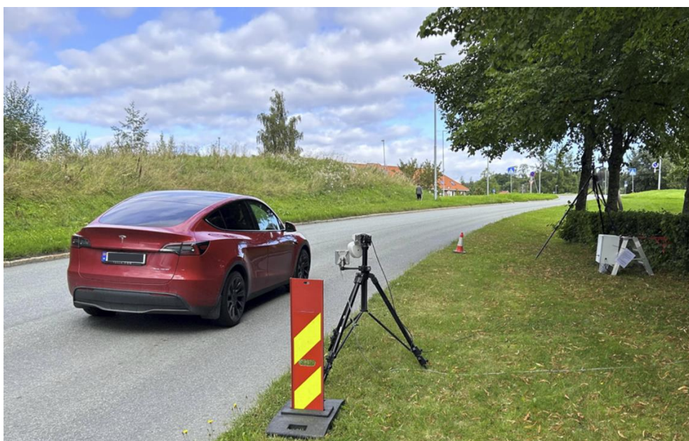
Figur 3-1. Målelokasjon 4. Radar og kamera i forgrunnen. Instrumentskap og mikrofonsystem i bakgrunnen.
