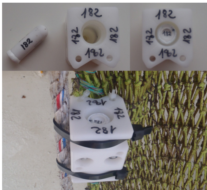
Figur 6. Star-Oddi Tilt sensor og husing (a) - øverst til venstre, (b)- øverst til høyre, og innfesting til not med strips (c)- nederst.
