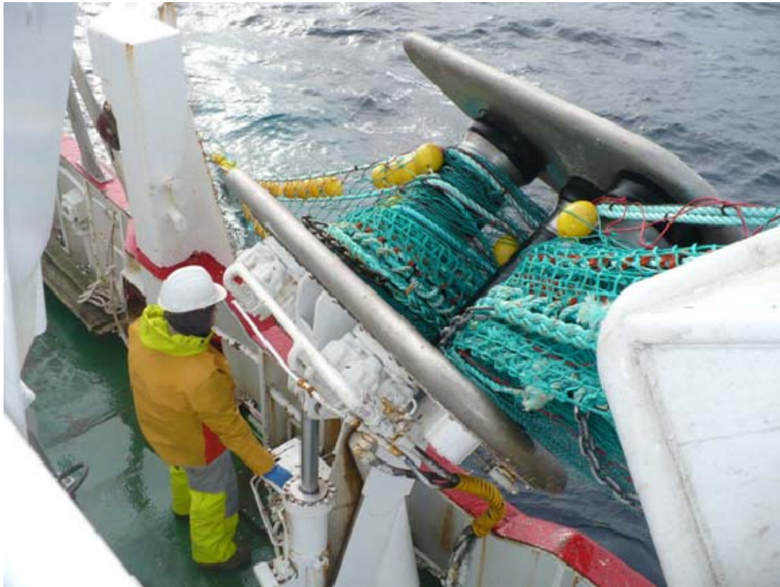
Bilde 6-10 Tørking av snurrevadsekk ved bruk av kraftblokk (notvinsj) (foto: SINTEF Fiskeri og havbruk)
