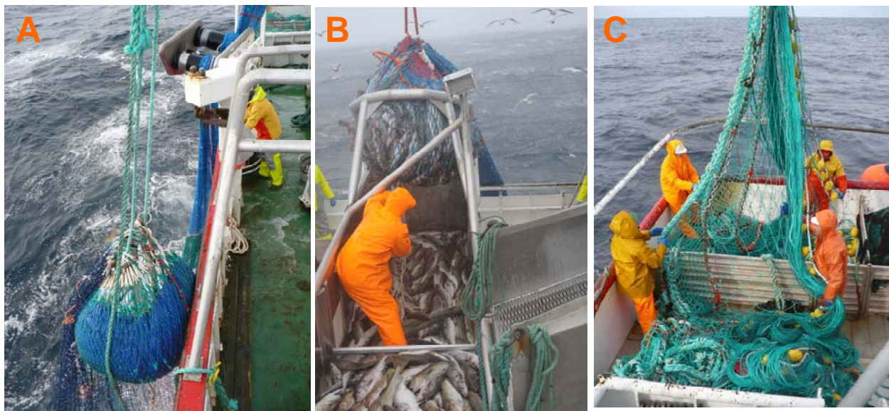
Bilde 5-4 Bilder av fangstoperasjoner. A) Ombordtaking ved hjelp av sekking, ca 500 kg sløyd fisk pr sekk, B) ombordtaking i tørrbinge i storm, C) inntak av snurrevadnota.
