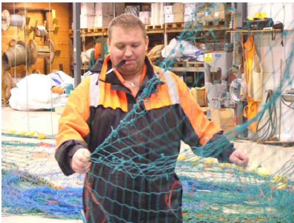
Bilde 6-3 Skipper Tom Grande reparerer not ved Myre Redskapsentral (foto: SINTEF Fiskeri og havbruk)
