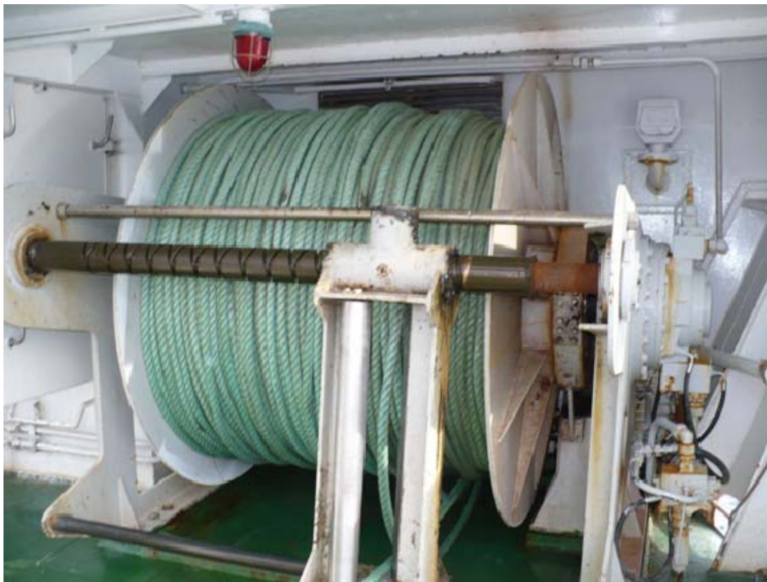
Bilde 6-6 Kombinasjonsvinsjer – 12 tonn - for snurrevad, not og evt. trål (foto: SINTEF Fiskeri og havbruk)
