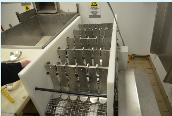
Figur 7 – Elektrobedøveren som ble benyttet på tokt med M/S Helmer Hansen. Denne versjonen av STANSAS #1 hadde 5 rekker à 6 elektroder som fungerte som motelektrode (+) til transportbåndet av stål (-). Bedøveren ble også testet ut med 3 rekker. Foto; SINTEF Fiskeri og havbruk
