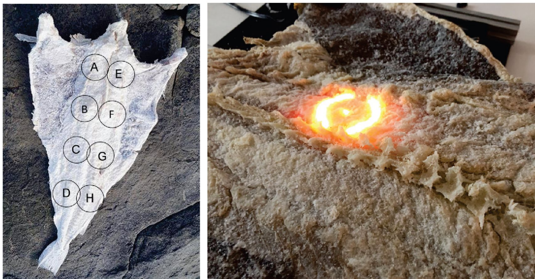
Figur 4 Målepunkter for hver fisk (venstre). Måling på ett målepunkt med GreenEye (høyre).
