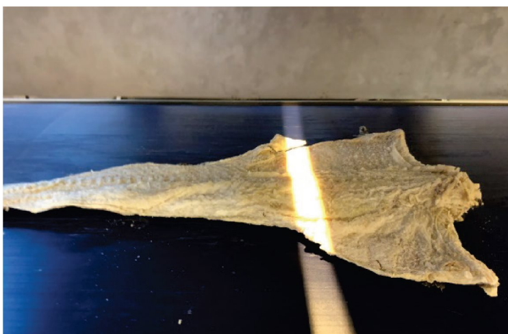
Figur 5 Skanning av klippfisk på transportbånd. Hele fisken måles på ett sekund.
