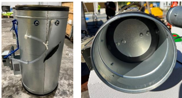
Figur 3: Skader på spjeld. (a) smeltede slager og (b) tilluftsspjeld som lukket seg helt.
