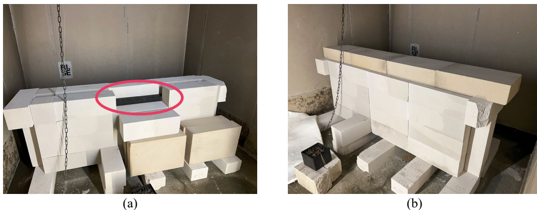
Figur 3-2: Madrassoppsett for test 8. I (a) er en blokk løftet bort for å vise madrassens posisjon, i (b) er lokket av blokker også på plass.
