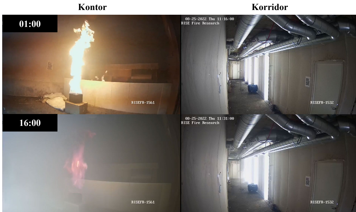
Figur 4-53: Bilde fra kontoret (øvre venstre) og korridoren (øvre høyre) 1 minutt etter start av test 11 og kontoret (nedre venstre) og korridoren (nedre høyre) etter 16 minutter.
