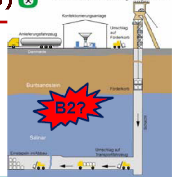
Schematische Darstellung Versatzverfahren Big-Bag-Versatz
