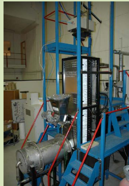
Multi fuel reactor/energilab NTNU og SINTEF
