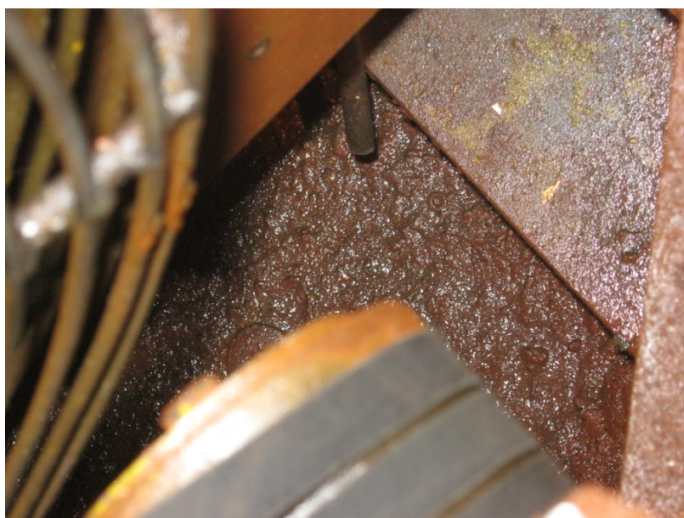
Figur 8 Kjølevæske av rødbrun farge på matter under kranmotor
