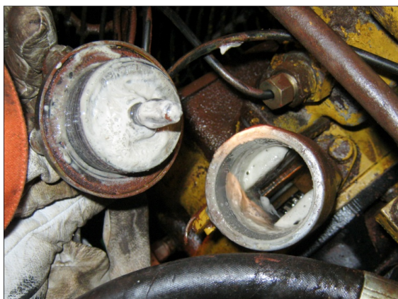
Figur 1 Påfyllingslokk og stuss for motorolje, motor A etter havariet
