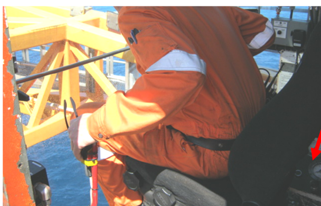
Figur 10 Kranfører i krankabin, instrumenter for overvåking av motorer er plassert til høyre og delvis bak kranfører når kranen kjøres
