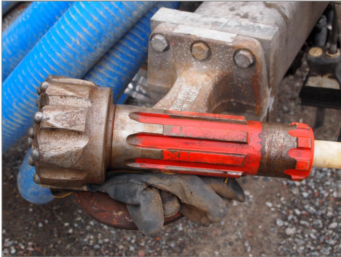
Figur 11: Borekrone brukt av Båsum Boring AS ved boring av grunnvarmebrønner ved Føyka.
