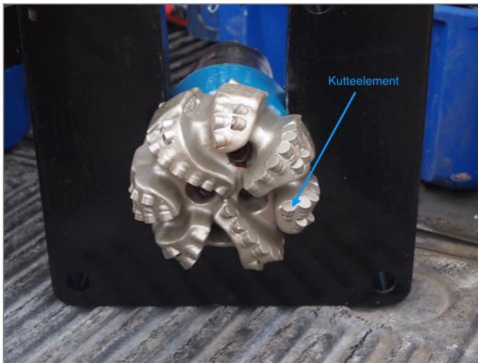
Figur 13: PDC-borekrone tilhørende Båsum Boring AS. Kutteelementene har blitt montert med et «støv» av diamant ytterst på flaten.
