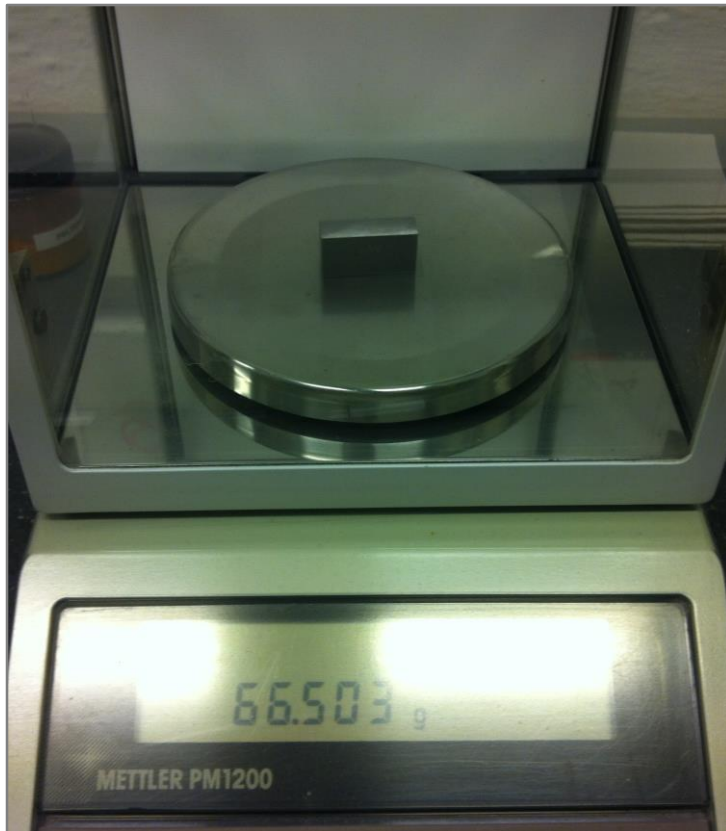
Figur 18: Veiing av wolframkarbidprøve for bestemmelse av abrasjonsverdi.
