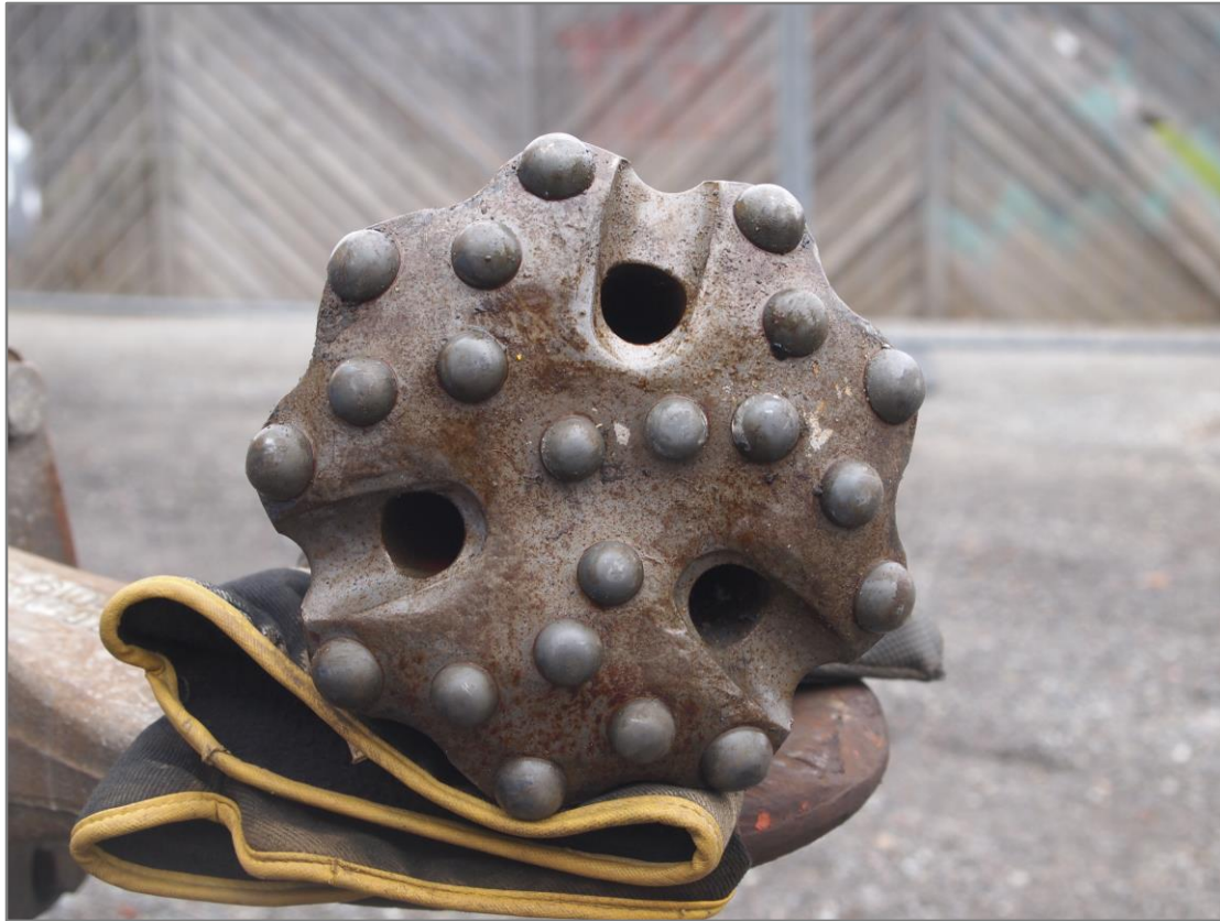
Figur 10: Borekrone med integrerte wolframkarbidbiter tilhørende Båsum Boring AS.
