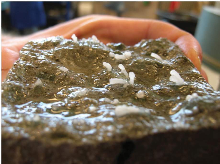
«Alkalisilika-ormer» som sveller ut av et prøvestykke i laboratoriet: Under den kjemiske reaksjonen løses silika ( \text{SiO}_2 ) i bergartene opp, og det dannes en alkalisilika-gel. Gelen kan trekke til seg vann og ekspandere, og betongen kan risse opp. Foto: SINTEF Byggforsk
