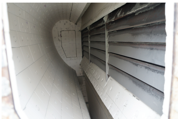
Kammer til et GI-type vindsikt
