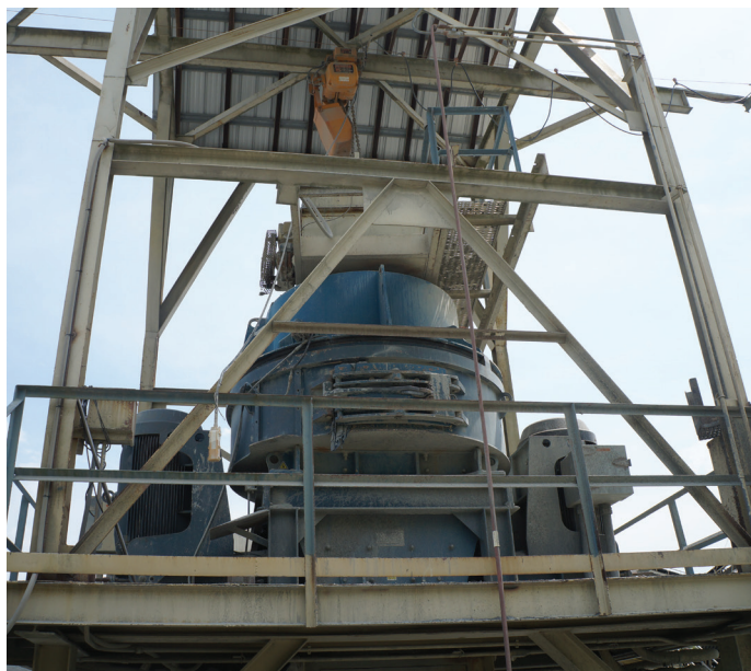
VSI knuser ( Vertical Shaft Impactor eller «kubisator»)
