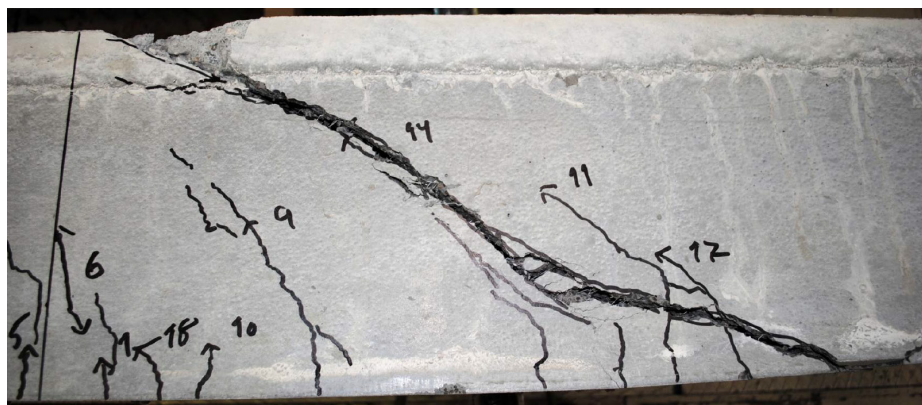
Typisk skjærbrudd i hybridbjelke. Foto: Linn Grepstad Nes
