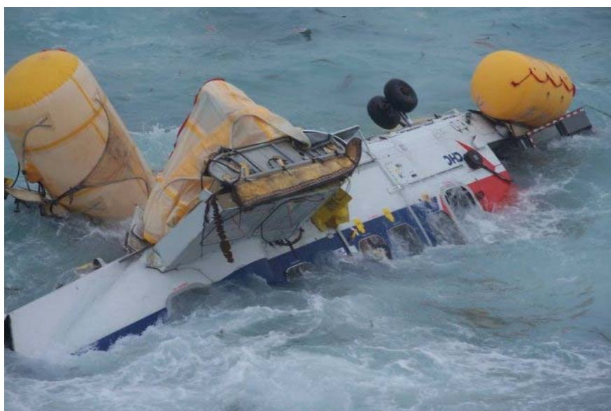
Figur 7.3: Flyteelementer som hindrer at helikoptre går rundt, men heller blir liggende lavt og skjevt med luftlommer i kabinen, vil kunne overflødiggjøre nødvendigheten av å ha tiltak rettet mot å minske konsekvensen av at helikopteret velter. Bildet er fra Sumburgh-ulykken i 2013. (Kilde: The Shetland Times)
